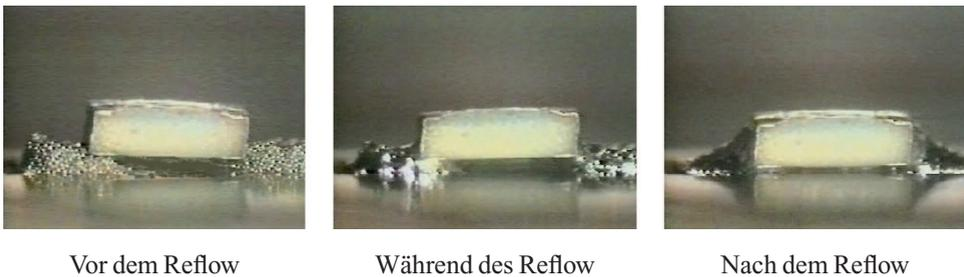
Abb. 1.1: Der Reflowprozess an einem 0402-Chip
