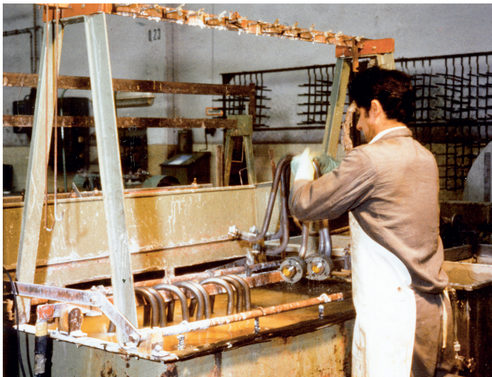
Abb. 2.1: Schwere Handarbeit Mitte des 20. Jahrhunderts zur Erzeugung galvanischer Qualitätsoberflächen mit hoher Gebrauchsdauer
