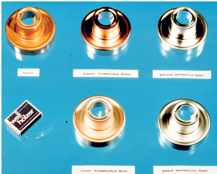
Abb. 3.2: Substitution der konventionellen Salpeter-Schwefelsäure-Brenne (obere Reihe) durch Chromschwefelsäure (untere Reihe) führte zu verändertem Aussehen der Oberfläche auch nach dem galvanischen Versilbern (rechte Seite)
