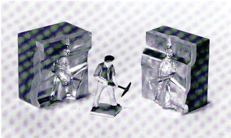
Abb. 4: Zwei Formenhälften mit komplizierter Trennfuge. Werkfoto Rotoplas Limited, London.
