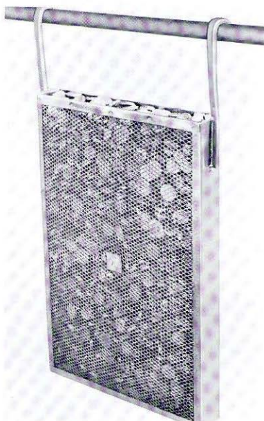
Abb. 11: Mit 'S' Nickel Rounds gefüllter Normal-Titankorb.
