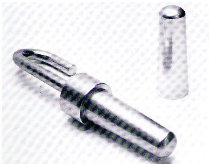
Abb. 1: Der mit Nickel galvanoformte Konus ist die naturgetreue Wiedergabe des hierfür benutzten Modells aus nichtrostendem Stahl.
