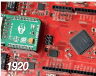
Für KI-to-go: Entwicklungsboard von Infineon für Edge-computing-Anwendungen
