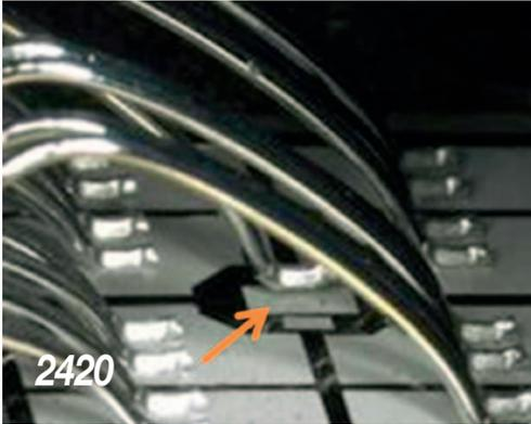
Graphit zwischen Chip und keramischen Schaltungsträgern – Einbindung und Auswirkung von Graphit im leistungselektronischen Aufbau
