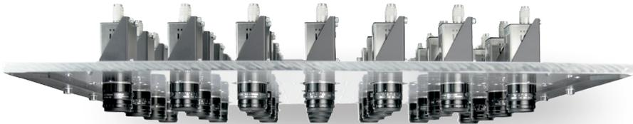
**1750** Immerhin 120 Megapixel für die THT-Bauteilprüfung auf engstem Raum. Hier werden besondere Anforderungen an AOI-Systeme für THT-Baugruppen durch die notwendigen Durchfahrhöhen von teilweise über 100 mm und/oder die beidseitige Inspektion gestellt. Generell sollen dabei die eingesetzten AOI-Systeme nicht zum Flaschenhals der Durchsatzzahlen werden
