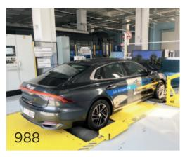
Ein Multifunktionsprüfstand für autonome und teilautonome Fahrzeuge, um hochpräzise Verkehrs- und Umweltsimulationen abbilden zu können
