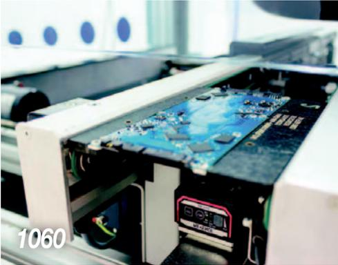
Kein AOI: Ein ausgeklügeltes Lasermessverfahren gleicht die Wirklichkeit vielschichtig gegen auf CAD-Daten basierende Sollvorgaben ab
