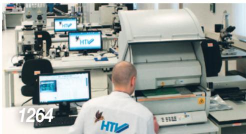
Röntgen-Fluoreszenz-Analyse: Sie ermöglicht als effiziente Inspektionsmethode eine schnelle und effektive Qualifikation oder auch serienbegleitende Qualitätskontrolle der Beschichtung von Steckkontakten
