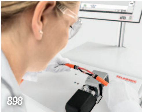
Litzenschweißen mit Ultraschall gilt immer dann als Mittel der Wahl, wenn zuverlässige elektrische Verbindungen erforderlich sind
