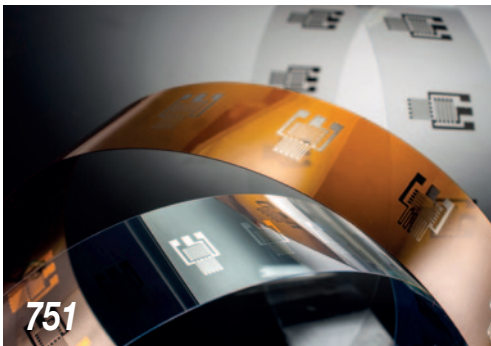
Die Arbeitsgruppe Dünnschichtverfahren am Fraunhofer ILT hat sich auf hauchdünne, mittels Laserverfahren gedruckte Schaltungen spezialisiert
