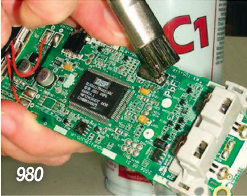
In der Elektronikfertigung bei der Baugruppenreinigung ist Alkohol als Reinigungsmittel ein Problem – einige Ratschläge zur Anwendung
