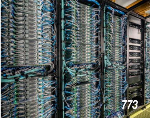
Neuer Hochleistungsrechner mit über 24 000 Rechenkernen und 74 Terabyte Hauptspeicher für eine Billion Rechenoperationen pro Sekunde
