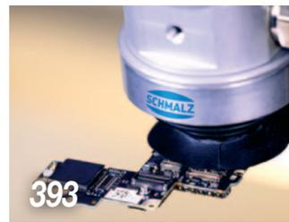
Mittels Vakuumgreifer lässt sich die Produktion von Smartphones automatisieren
