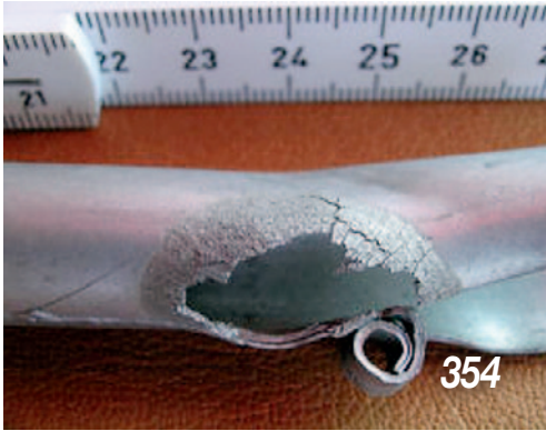
Pestilenz: Diese kann auch als Zinnpest in der Elektronik bei Zinnlot auftreten – zum Beispiel bei hoch-zinnhaltigen Legierungen
